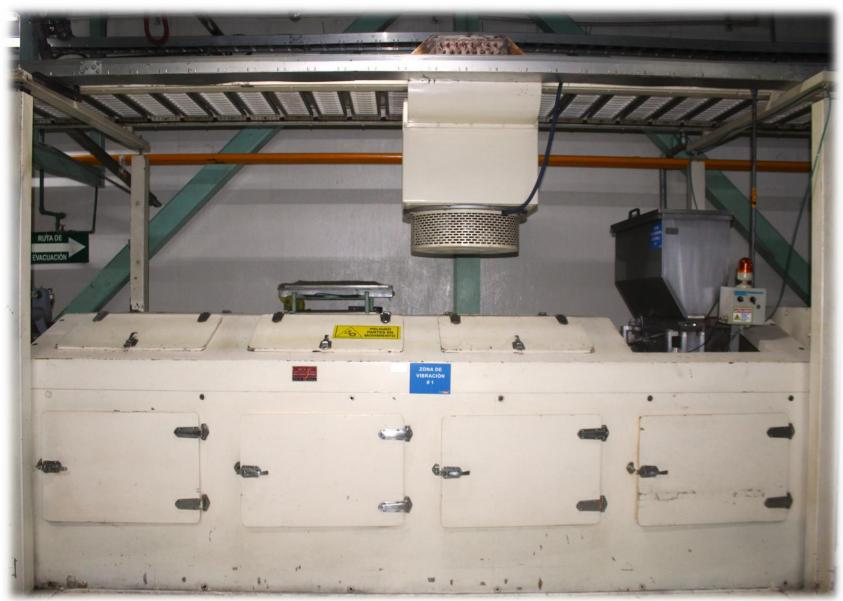
Función: Distribuir el chocolate a todo el molde por medio de vibración y dosificar el cereal potenciado para su posterior enfriamiento .
