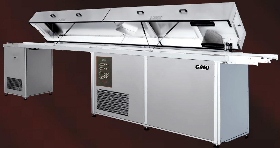
Utilizzati per ottenere una perfetta asciugatura di prodotti ricoperti. Il raffreddamento avviene tramite ricircolo di aria ad anello controllato da scheda elettronica. Il gruppo di raffreddamento, di limitata potenza, controlla anche l'umidità per ottenere un ottimo risultato finale.
